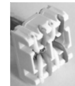
⑥ Adern an der Aderanlegekappe mit einem Seitenschneider bündig schneiden.
