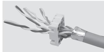
Verdrillte Aderpaare zusammen in die mit Farben und Zahlen gekennzeichneten Löcher der Aderanlegekappe einführen.
