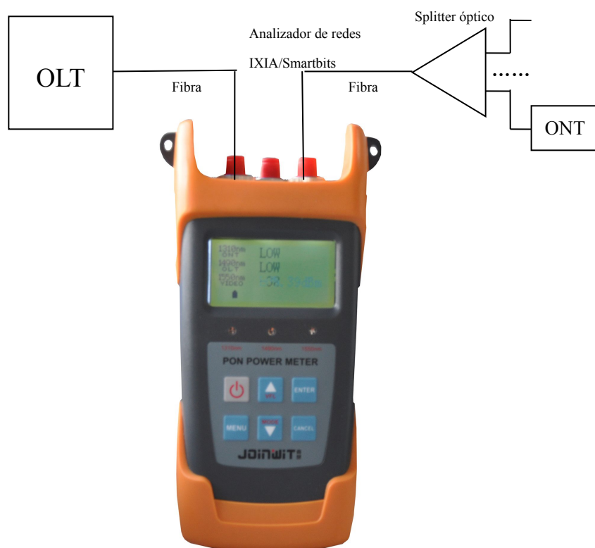
Diagrama de configuración de prueba de potencia óptica OLT PON
