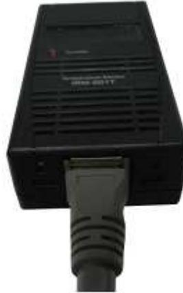
Figura 8-5 Conexión de la tarjeta UF-RS485 al sensor de temperatura de la batería
