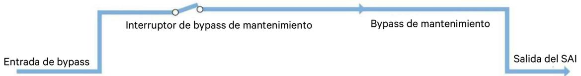
Figura 1-6 Diagrama de línea de modo operativo de mantenimiento
